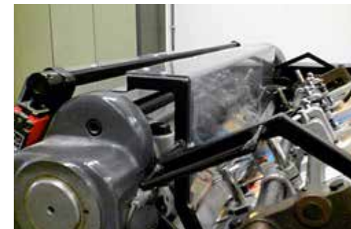
Beschermkap tussen inlegtafel en cilinder HCA
