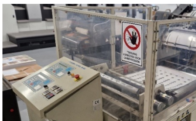
Voorbeelden van geplaatste afschermingen op machines (bron: Grafimedia)
