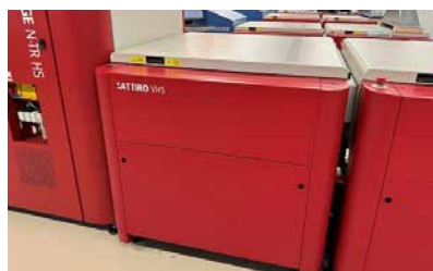
Voorbeelden van volledige afscherming van machines (bron: Grafimedia)
