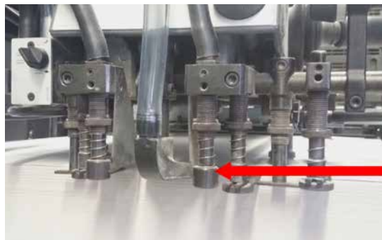
Scherpe voorkant ventilatorvoet (zie rode pijl)
