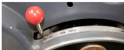
Voorbeeld van een noodstopvoorziening
