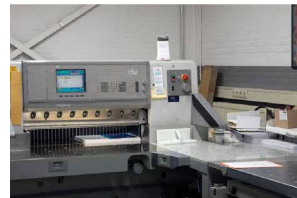
Voorbeeld van een snijmachine met tweehandenbediening (bron: Grafimedia)
