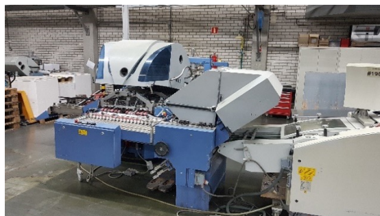
Voorbeeld van een nabewerkingsmachine met een geluids-reducerende kap
